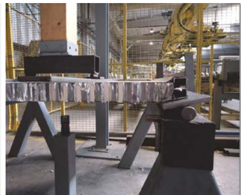
Foto 3 en 4: bezwijkvormen van de plaat in de 4-punts buigproeven, links het bezwijken van de kern van de plaat en rechts het bezwijken van de lijmverbinding tussen de stalen buitenplaat en aluminium profiel BM-P-100
