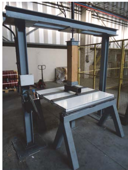
Foto 1: proefopstelling van de 4-punts buigproeven
